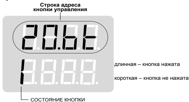
Рисунок 6 – Пример табло показывающего прибора при просмотре состояния кнопки
