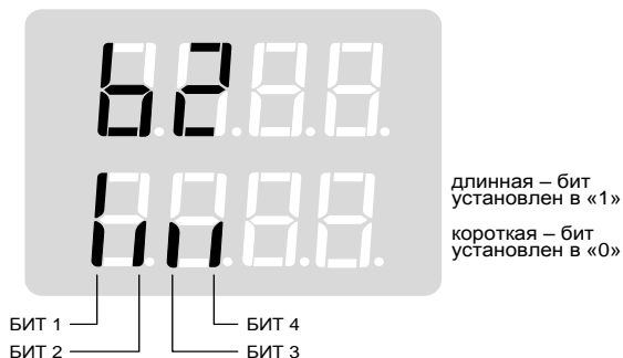
Рисунок 5 – Пример табло показывающего прибора при просмотре / установке значения параметра b2
